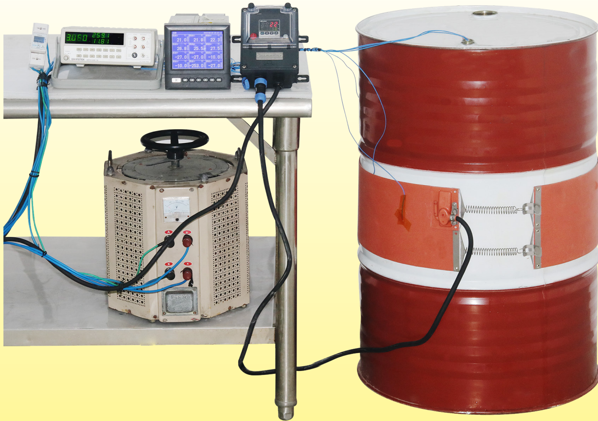
Variación de la temperatura versus el tiempo de un tambor de metal de 220 litros, lleno de agua , calentado por una cinta calefactora de silicona de 200 mm de ancho, sin aislamiento térmico, potencia de 1500 W (carga superficial de 0,5 W/cm 2 ).
